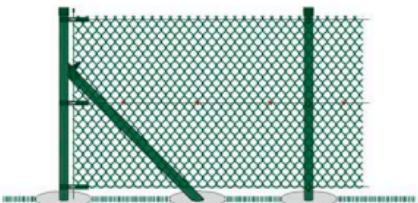
Horný a spodný napinaci drôt zasunieme medzi spodné a horné oká pletiva a v strede pletivo uchytíme (minimálne 3x medzi stĺpikom) viazacím drôtom resp. sponami Rocafix. Koniec pletiva upevníme tak, že pri poslednom stĺpiku vypletíme špirálu a pletivo praviažeme viazacím drôtom.
