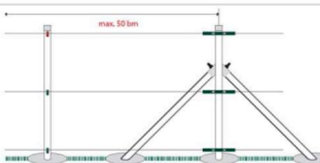
Kedže s jedným napínákom môžeme napnúť max. 50 m napinacieho drôtu, na zodpovedajúci stĺpik pripevňíme obdobne napínáky a pomocou vidlicového klúča vyspívame napínacie drôty. Po napnutí drôtu tieto zasunieme do prichytek upevnených na stĺpikoch a dotláčime háčik, ktorý je súčasťou prichytky. Toto nám zaistí stále napnutie napinacieho drôtu medzi stĺpikmi.
