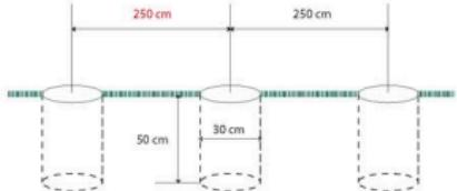
**Priprava:** Do vopred vyhlibených dier priemeru 30 cm a hĺbky 50 cm osadíme profilové stĺpiky a zasypane súchým betonom. Stĺpiky sú od seba vzdialenosť 2,5 m. Každý začiatok, koncový a rohový stĺpik musí mať jednu resp. 2 vzpery.
